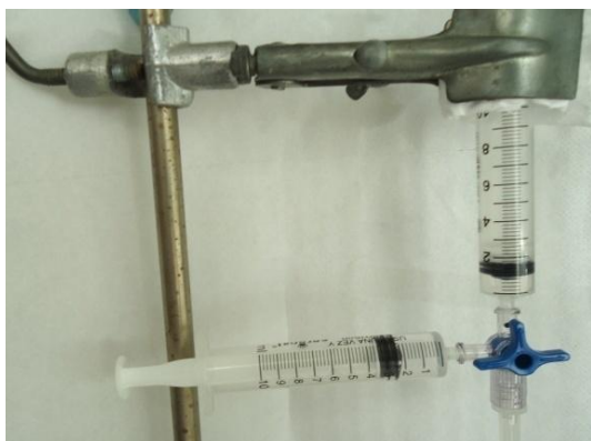
Figura 1. Dispositivo para obtención de gas hidrógeno. En posición horizontal se ubica la jeringa que contiene el ácido clorhídrico y en vertical la que contiene la cinta de magnesio.
